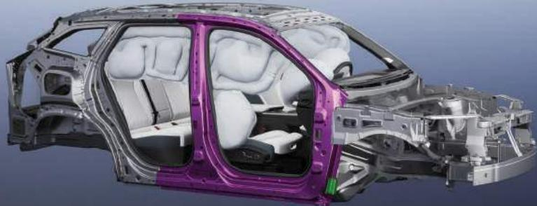
وسائل هوائية وهيكل فولاذی
